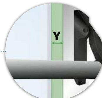
Abstand zwischen der Glasoberfläche (oder Türblatt) bis zur Außenkante der Rahmenoberfläche.
