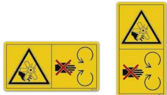
Während des Betriebes Schutzeinrichtungen nicht öffnen oder entfernen.
