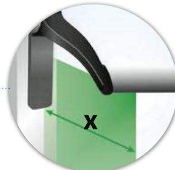
Abstand zwischen der Außenkante der Rahmenoberfläche bis zum Auflagepunkt des Stangengriffes.
