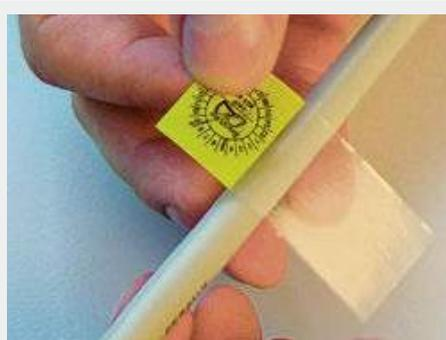
Lösen Sie die Kabelprüfplakette vom Sammelbogen und kleben das Prüfplakettenfeld um das Kabel.
